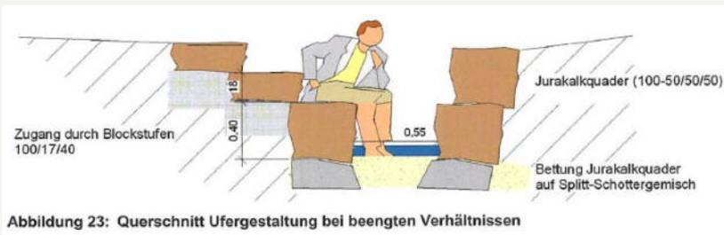
Abbildung 23: Querschnitt Ufergestaltung bei beengten Verhältnissen
